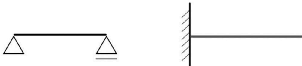
『静定構造物』というものは、安定構造物の中で、3つの力のつり合いの条件式 ( $\Sigma V=0$ 、 $\Sigma H=0$ 、 $\Sigma M=0$ ) で反力や断面力が求められるものを指します。
