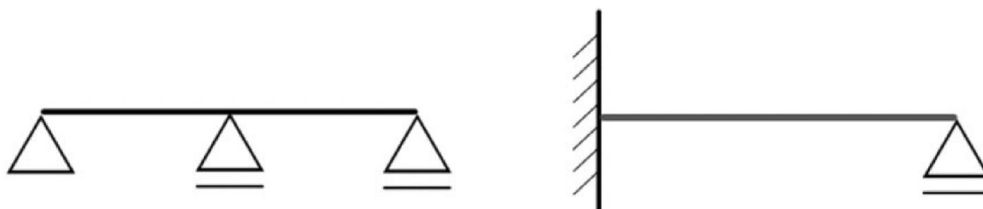
反対に『**不静定構造物**』というものは、安定構造物の中で、3つの力のつり合いの条件式 ( $\Sigma V = 0$ 、 $\Sigma H = 0$ 、 $\Sigma M = 0$ ) で反力や断面力が求められないものを指します。
